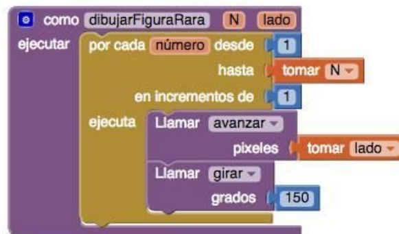
Figura 2.8: El procedimiento dibujarFiguraRara que usa una variable N en un loop.
