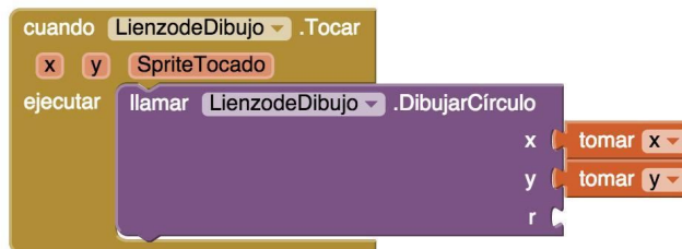
Figura 3.9: La aplicación sabe donde dibujar (x,y), pero todavía necesitamos especificar cuán grande debería ser el círculo.
