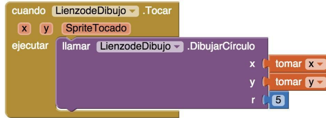
Figura 3.10: Cuando el usuario toca el LienzoDeDibujo , un círculo de radio 5 será dibujado en las coordenadas (x, y) correspondientes.
