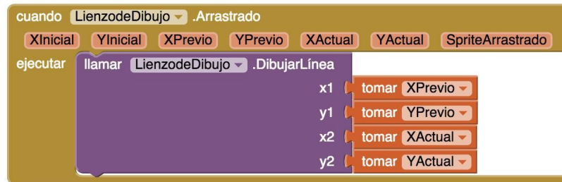
Figura 3.13: Cuando el usuario arrastre el dedo, la aplicación dibujar una línea desde el punto anterior hacia el actual.
