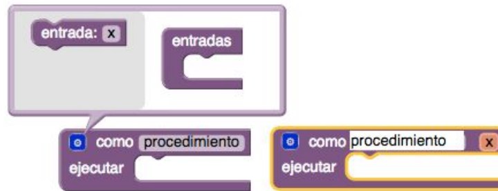
Figura 2.4: Creando un procedimiento con parámetros.
